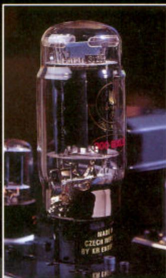
Diese 1997 neu entwickelte Röhre stammt aus den Anfängen von Dr. Krons KR Enterprise. Ihr Glühen ist durch das eingefärbte dicke Glas fast nicht zu sehen. Beansprucht aufgrund eines neuartigen Molybdän-Kathodenträgers einen höheren Heizstrom (2 A statt 1,3 A) und leistet etwa die Hälfte mehr als die WE 300B, lässt sich aber nicht ohne weiteres gegen diese austauschen. Klingt warm und satt. Bei Black Forest Audio.
